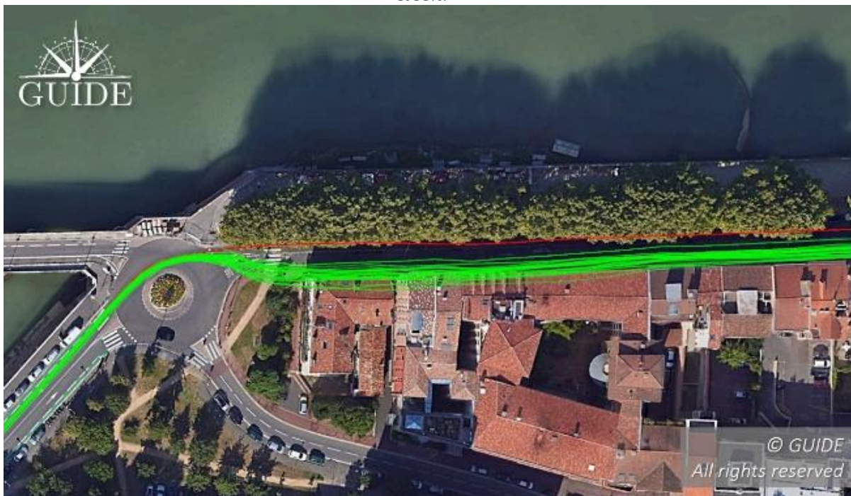
Figure 10 - Visualisation de la combinaison d'erreurs Déterministe et Non déterministe, dans une rue bordée d'arbres d'un côté et d'habitations de l'autre.
