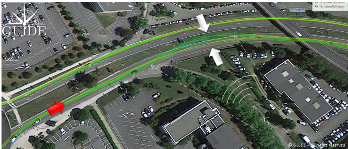
Figure 6 - Effet du brouillage des signaux GNSS sur des récepteurs sous l'effet d'interférents légers
